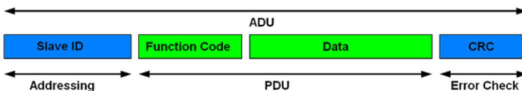
Fig. 28: Diferencias de Modbus/TCP y Modbus/RTU.
