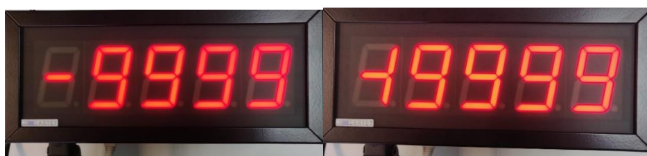
Fig. 54: A gauche, valeur minimale en "FULL DIGIT", -9999. A droite, valeur minimale en "HALF DIGIT", -19999.
